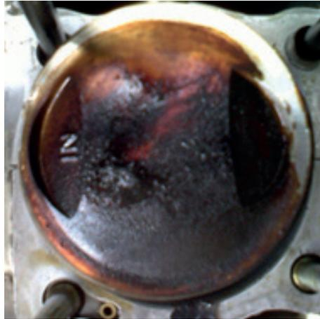
Figura 1. Efecto de la ignición en el proceso de combustión del GLP.
