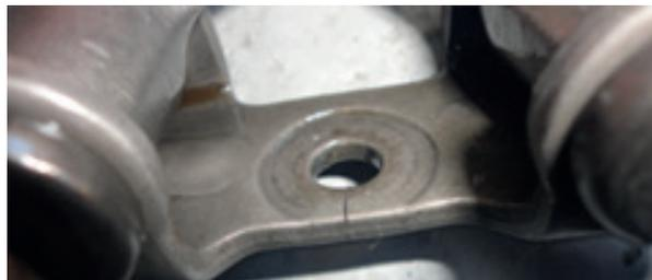
Figura 2. Fractura en la culata del motor.
