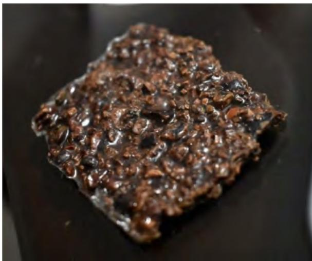
**Figura 4.** Nuevo material conglomerado (composite) cacao
