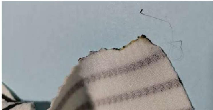
**Figura 4.** Muestra de cenizas para fibras sintéticas en análisis piromagnóstico.
