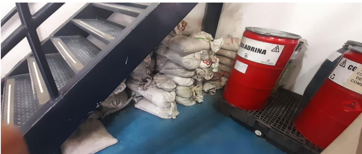
Imagen 3. Almacenamiento en estiba de contención o antiderrames.
