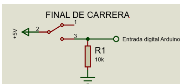
Figura 26. Esquema de conexiones del sw de fin de carrera.
